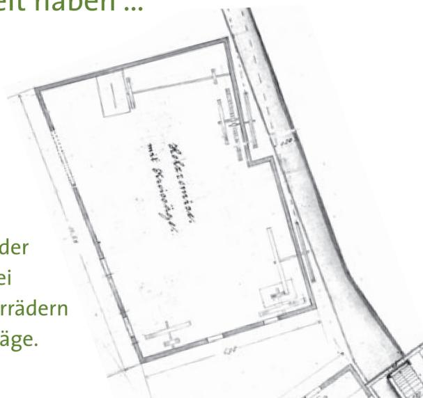
Grundriss der Holzsägerei mit Wasserrädern und Kreissäge.
