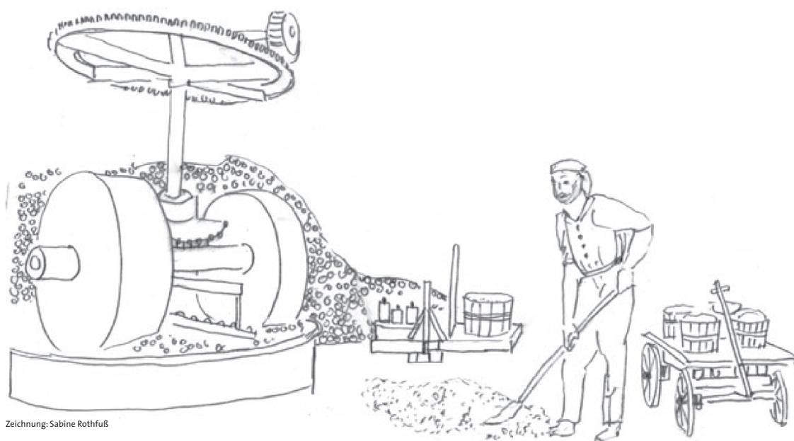
**G**esteinsmehl ist ein wichtiger Rohstoff für die Glasherstellung. Die Granitbrocken aus den Steinbrüchen wurden zunächst zu Schotter zerschlagen und anschließend hier in der Gesteinsmühle staubfein zermahlen.
